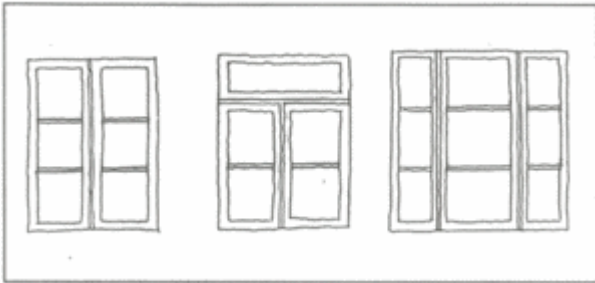
Figur 6: Atypiske vinduer: Dannebrogsvinduer i frontspice/hjørnehusgavl, vindue i hjørnehusgavl og stuevindue i hjørnehus.
