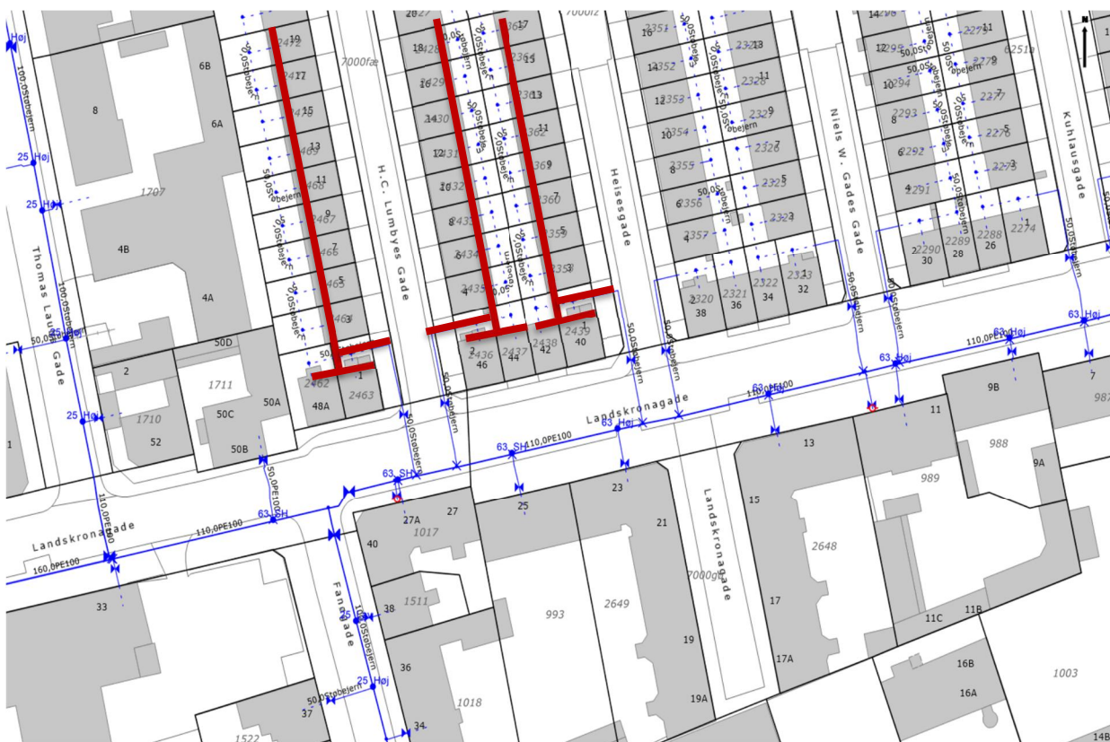
Princip for føringssveje i kælder mod havesiden.
