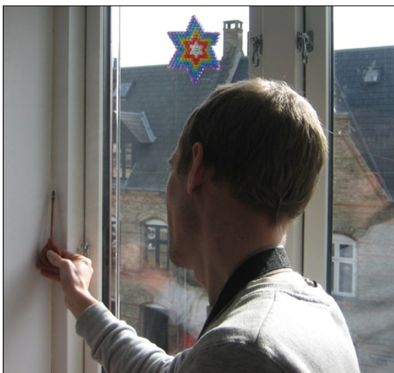
Med en lille pipette puster man røg ud langs vinduesrammen for at se, hvor der er utæt
